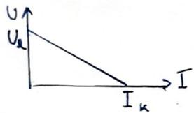
úbytek napětí na vnitřním odporu zdroje
