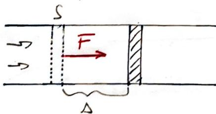
Kapalina působí silou  $\vec{F}$  na písl o obsahu  $S$  a posune ho po dráze  $\Delta$
