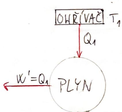
→ 2.TZ: Nelze sestrojit cykly pracující sepečným zdrojem, který by jen odebíral teplo z ohřívacího a dodával stejně mnoho práce
