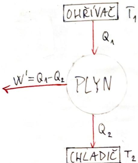
$$T_1 > T_2 \quad \wedge \quad Q_1 > Q_2$$
