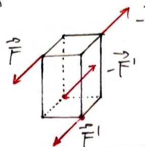
→ sroucení způsobují 2 dvojice sil s opačným otáčivým momentem
