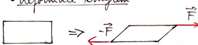
→ deformaci snytem způsobují sily stejně velké opačného směru, které působí v různých rovinách
